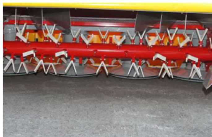
Aufbereiter mit Kunststoffzinken
